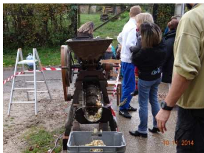
Les fruits lavés sont déposés dans un casse pommes pour être broyés.
